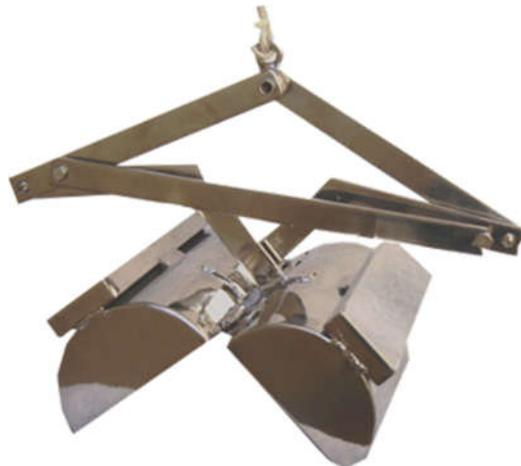
Figura 1: Dragas Petersen utilizadas na coleta dos sedimentos
