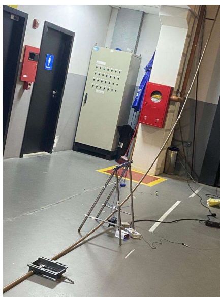
Figura 8 - Tubo ensaiado em geometria similar à de uma catenária real
