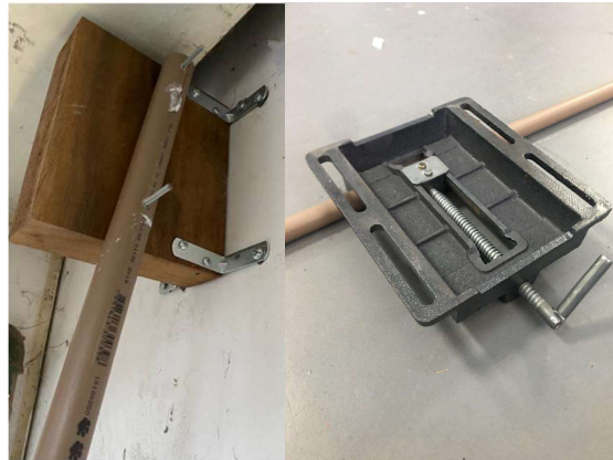
Figura 7 - Elementos para definição da condição de contorno da estrutura tubular. a) Suporte de madeira. b) Morsa
