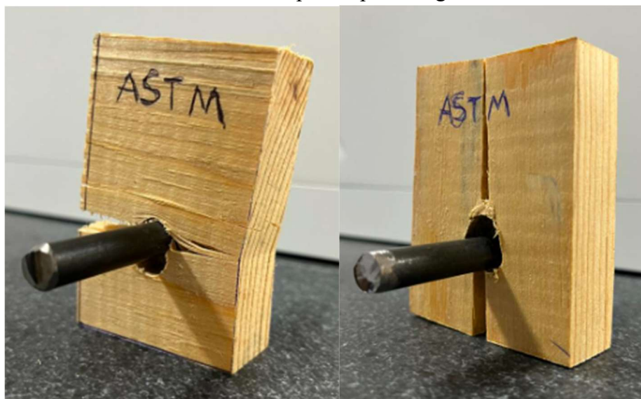
Figura 6 - Fendilhamento observado em corpos de prova segundo a ASTM D5764 (2018).
