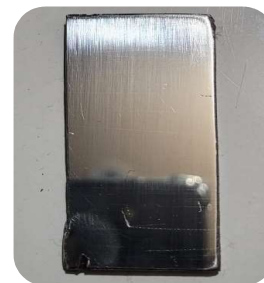
Figura 8 – CP de Corrosão.
