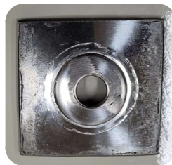
Figura 12 – CP ensaiado cisalhamento.
