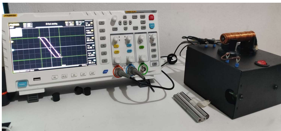
Figura 11 – Conjunto de aferição da curva de histerese magnética.
