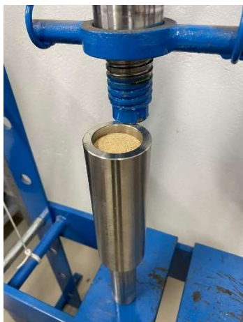
Figura 2 – Material em molde cilíndrico de aço.
