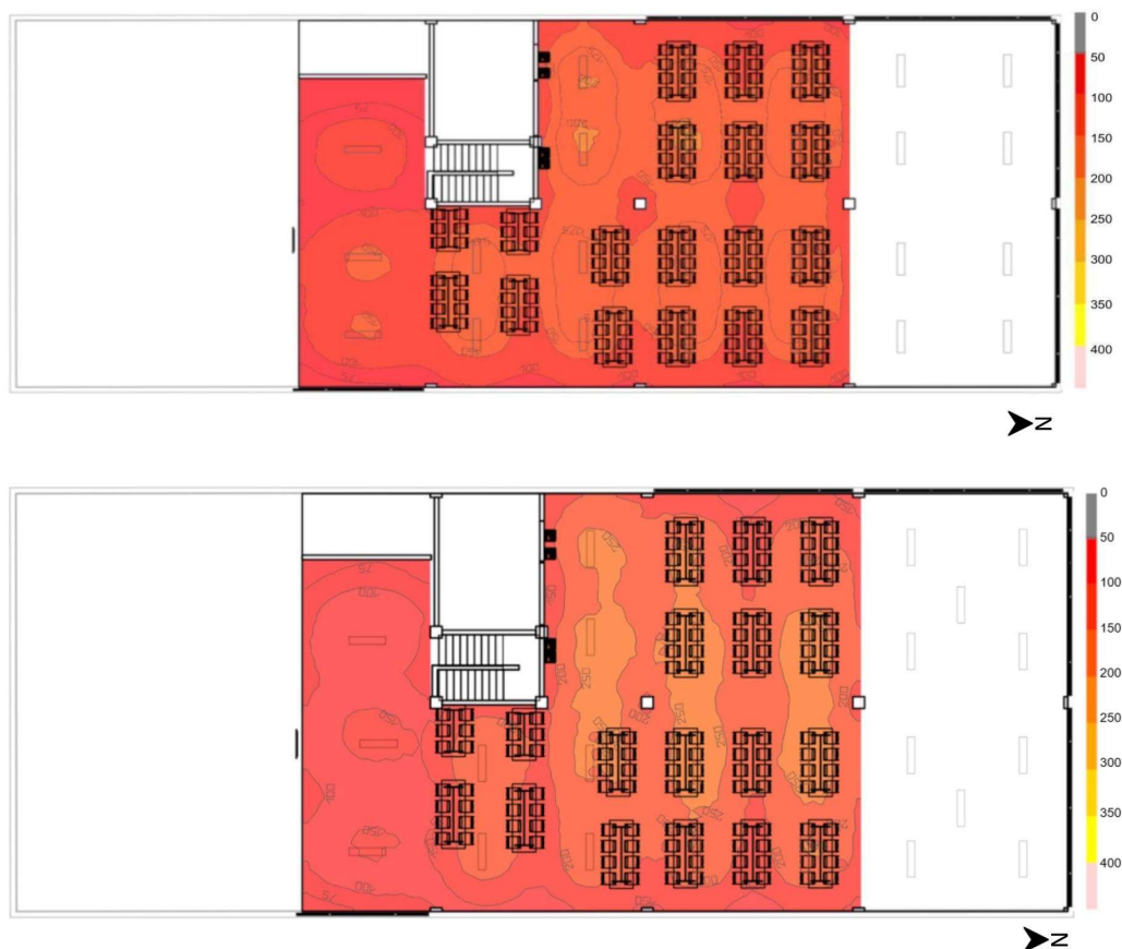
Figura 12 – Isocurvas de Iluminância para luz elétrica do pavimento superior na situação atual (acima) e para a proposta (abaixo)
