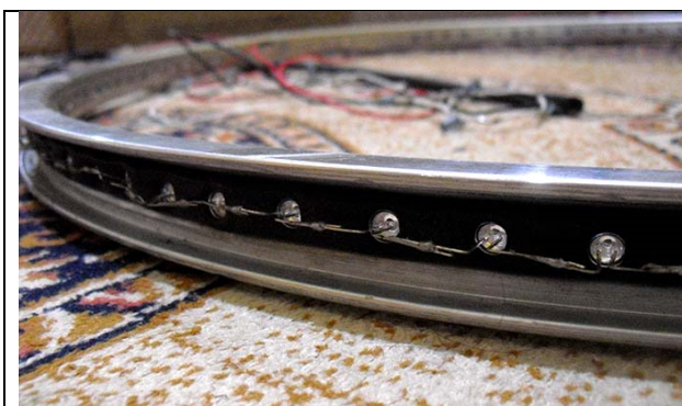
Figura 10a. Isolamento do circuito com borracha autoadesiva
