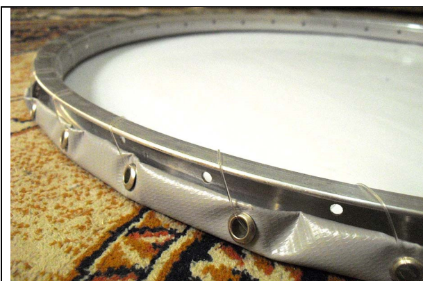
Figura 8a. Fixação da pele por meio de ilhós e linha de pesca
