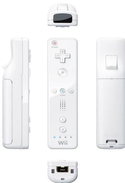
Figura 2. Visão em diversas perspectivas do controle-remoto Wiimote, onde a perspectiva frontal (acima) apresenta a câmera de captação de luz infravermelha.
