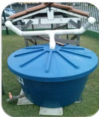
**Figura 1.** Protótipo com SAAP e reservatório instalado.
