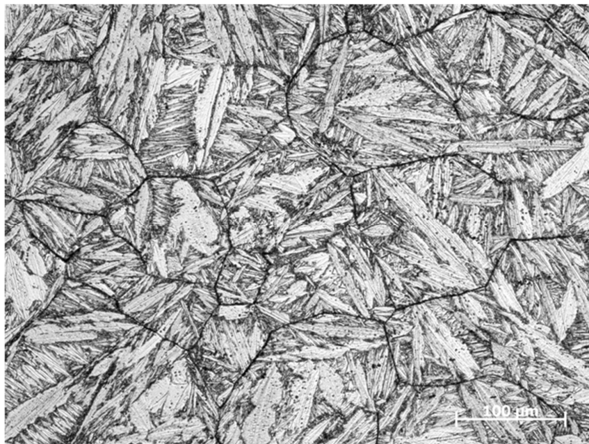
Figura 3.2.2.1 – Microestrutura da liga Fe-31Ni-0,02C após um ataque químico numa solução de 15 mL Nital (5%) + 4 mL HCl + 10 mL FeCl 3 (12,5% m/v). Ampliação original de 100x.
