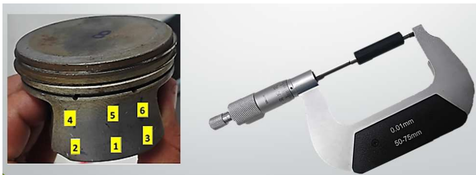
Figura 8 – Posição das 6 medições ao longo da saia / micrômetro
