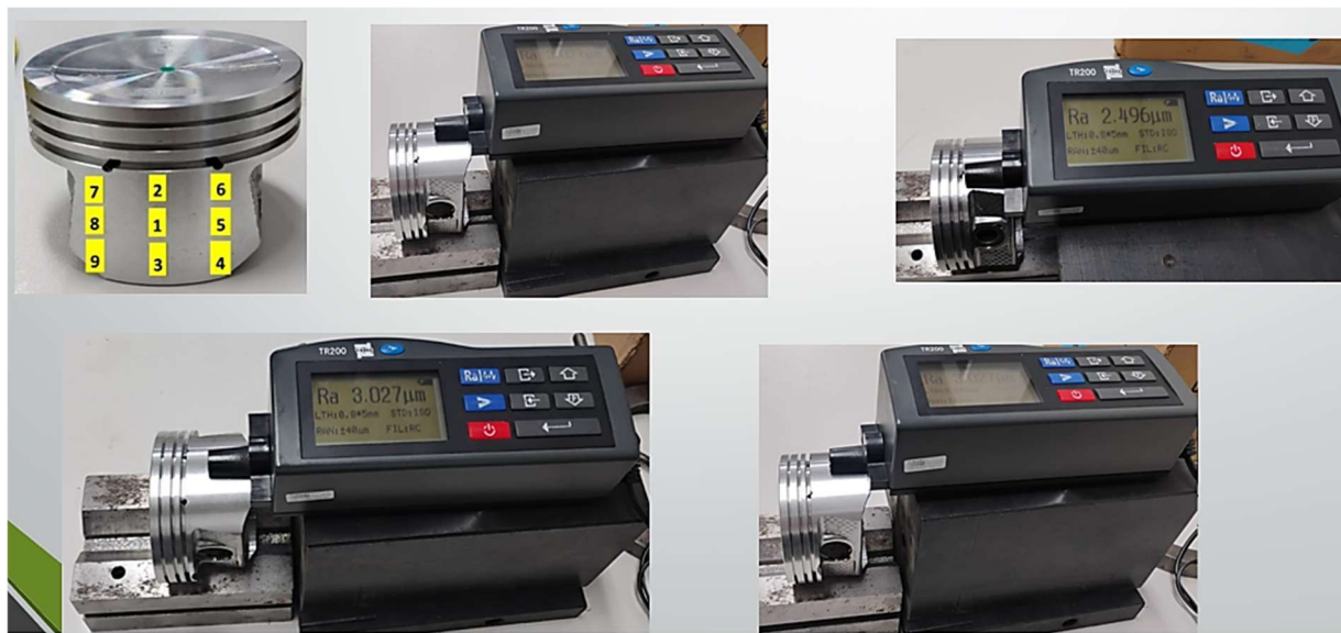
Figura 9 – Nove pontos de medição e ilustração da aplicação do rugosímetro
