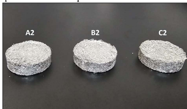
Figura 07: Amostras compactadas com 96 Mpa.
