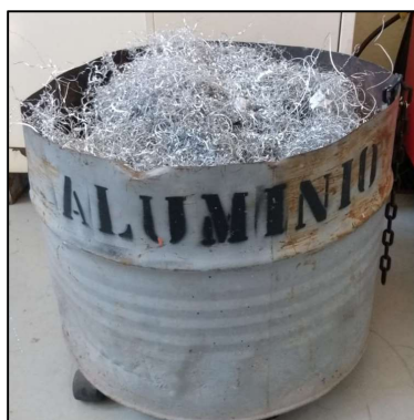
Figura 01: Cavacos da liga de alumínio AL 1060 T6 utilizados nos ensaios
