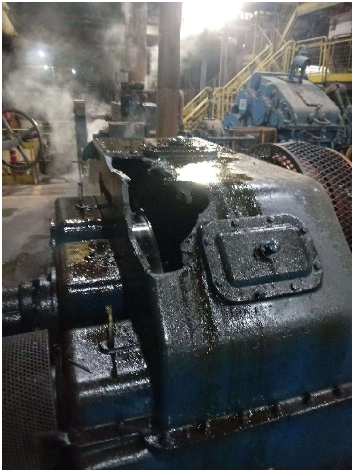
Figura 17 - Imagem redutor falha catastrófica
