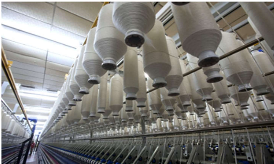
Figura 2: Maçaroca utilizada na parte superior do filatório anel
