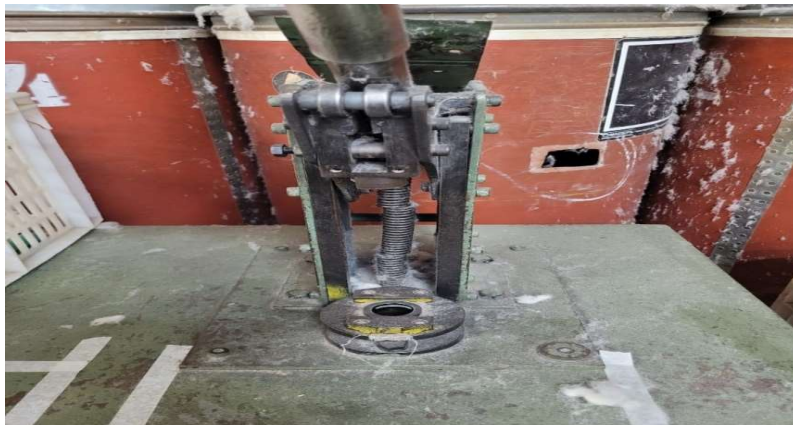
Figura 6: Prensa manual utilizada no desmanche de espula (frontal)
