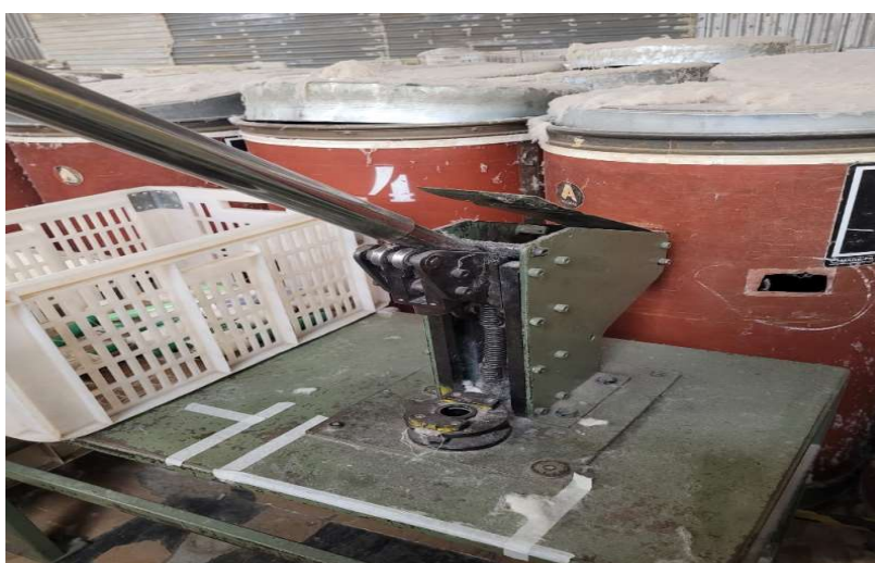
Figura 7: Prensa manual utilizada no desmanche de espula (lateral)
