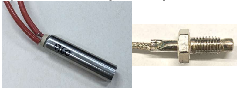
Figura 5: Cartucho elétrico e ponta do termopar com rosca M6
