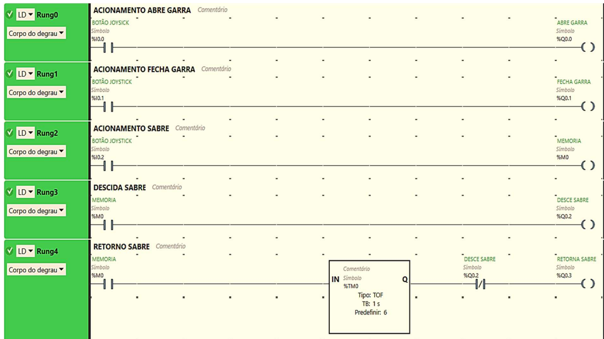
Figura 5: Programação ladder no software EcoStruxure Machine Expert – Basic
